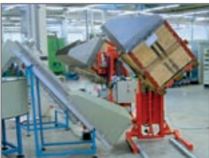
Χρήση Logiflex με πλευρική ανατροπή σε γραμμή παραγωγής.
