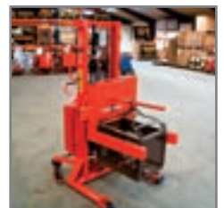
Περονόφορο με πλευρική ανατροπή και βελόνι για μεταφορά και ανατροπή κυτίων με καλώδια.
