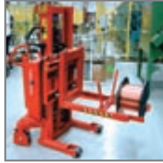
Περονόφορο με πλαγίως κινούμενο σασί για τη διαχείριση στροφείων χαλκού.
